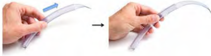
Abb. 6: Herunterschieben des Nitinolgeflechts vom Reinigungsschlauch
