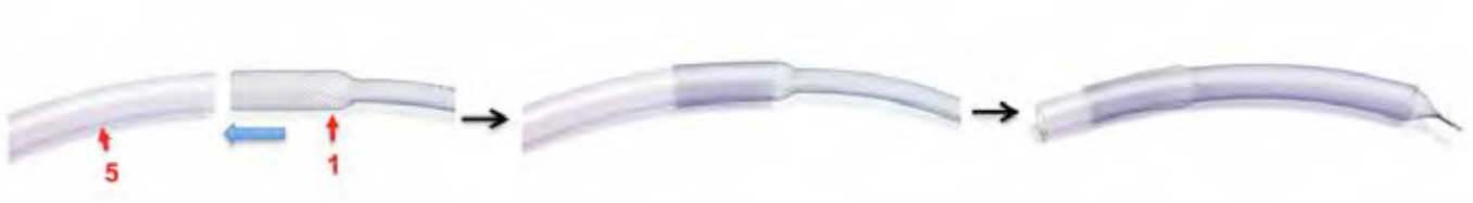
Fig. 5: Mettre le treillis de nitinol sur le tuyau de nettoyage
