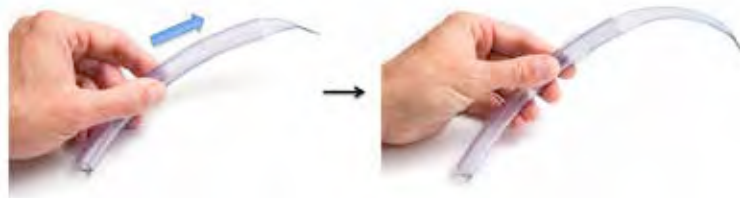
Abb. 6: Spinta della rete di nitinol dal tubo per la pulizia
